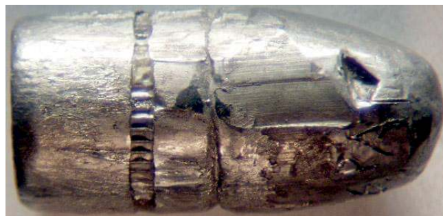
Figura 6. Marcas de fusión del metal. Laboratorio de Balística, -INACIF-.
