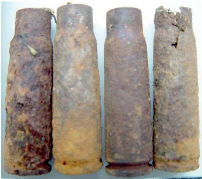
Figura 4. Casquillos dañados, no aptos para análisis comparativo. Laboratorio de Balística, -INACIF-.
