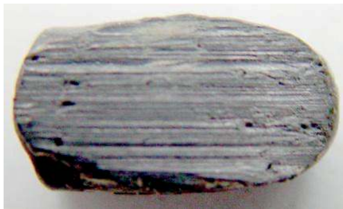
Figura 3. Proyectil dañado, no apto para análisis comparativo. Laboratorio de Balística, -INACIF-.
