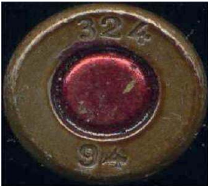
Figura 7. Lacas sellantes en el fulminante del cartucho. Laboratorio de Balística, -INACIF-.
