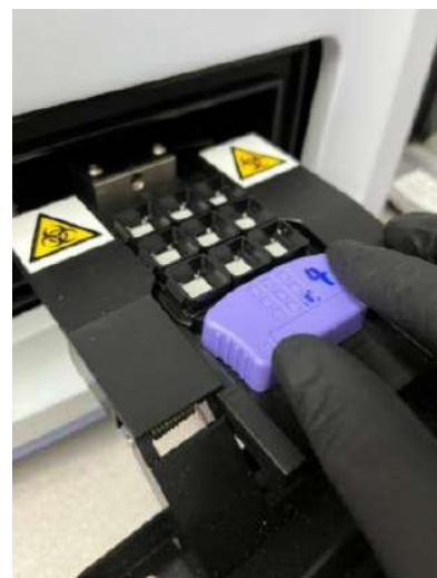
Figura 3. Colocación de bandeja portadora en el equipo
