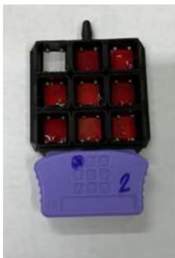
Figura 2. Bandeja portadora de biochips con muestra de sangre
