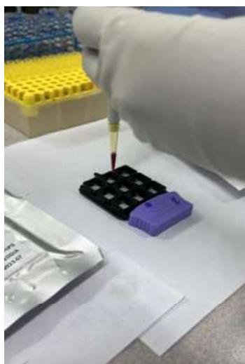
Figura 1. Bandeja portadora en proceso de colocación de muestra
