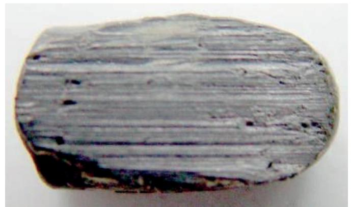
Figura 3. Proyectil dañado, no apto para análisis comparativo. Laboratorio de Balística, -INACIF-.
